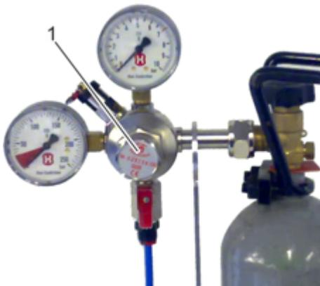
Abb. L: Druckregler öffnen
