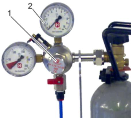
Abb. Q: CO<sub>2</sub>-Flaschendruck einstellen
