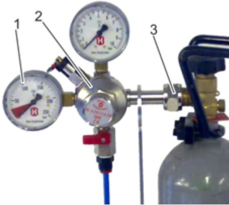
Abb. H: Manometerdruck prüfen
