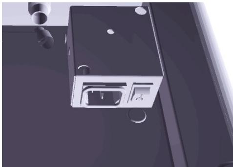
Der Ein/Aus-Schalter ist an allen Produktvarianten an der Unterseite direkt neben dem Netzanschluss angebracht.
