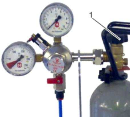
Abb. G: CO<sub>2</sub>-Flaschenventil öffnen
