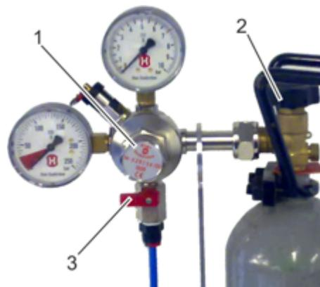
Abb. M: Gaszufuhr wieder schließen
