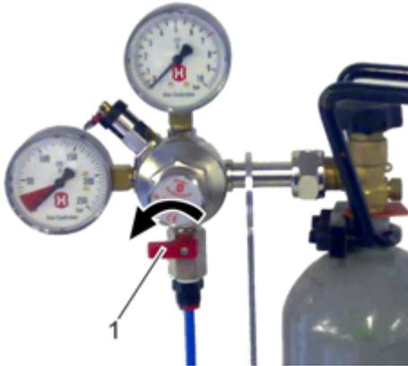
Abb. K: Absperrhahn öffnen
