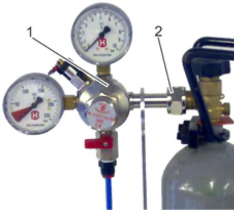
Abb. E: CO<sub>2</sub>-Druckminderer anschrauben
