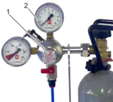
Abb. Q: CO<sub>2</sub>-Flaschendruck einstellen
