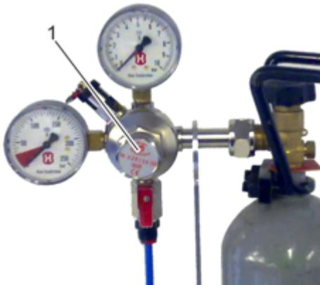
Abb. L: Druckregler öffnen
