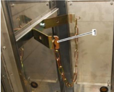
Abb. D: CO<sub>2</sub>-Flaschenhalterung
