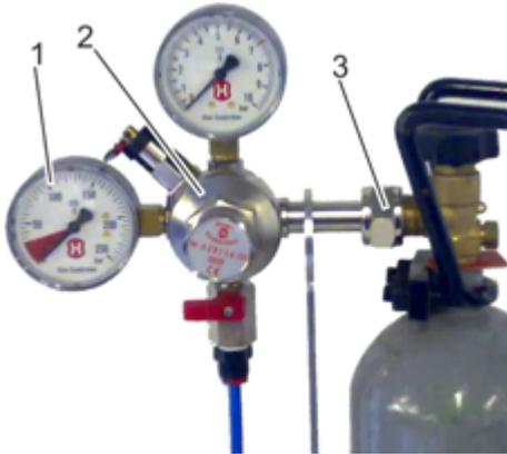
Abb. H: Manometerdruck prüfen
