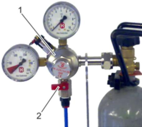
Abb. F: Absperrhahn schließen
