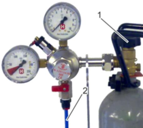
Abb. J: CO<sub>2</sub>-Flaschenventil öffnen
