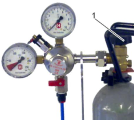
Abb. G: CO<sub>2</sub>-Flaschenventil öffnen
